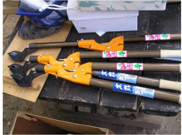
竹林整備用の新兵器「太丸」。倒した竹の枝切りに威力を発揮します(屈まずに作業が出来ます)。直径40ミリの枝も切れます
