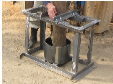
伐倒作業訓練台が出来上がってきました。塗装して完成です。片岡さん武田さん色々ありがとうございます
