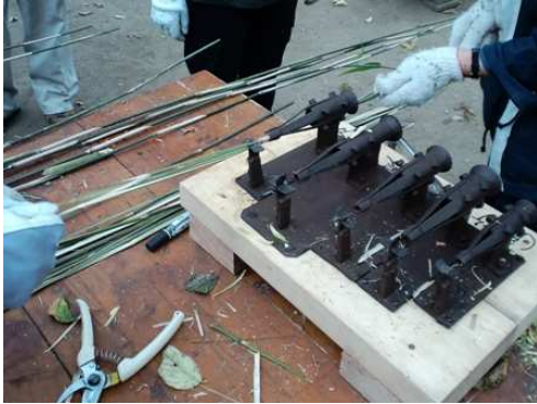
シノダケを籠(ひご)にする道具。ラッパ状の口から竹を入れて押し引くとアララびっくり!
